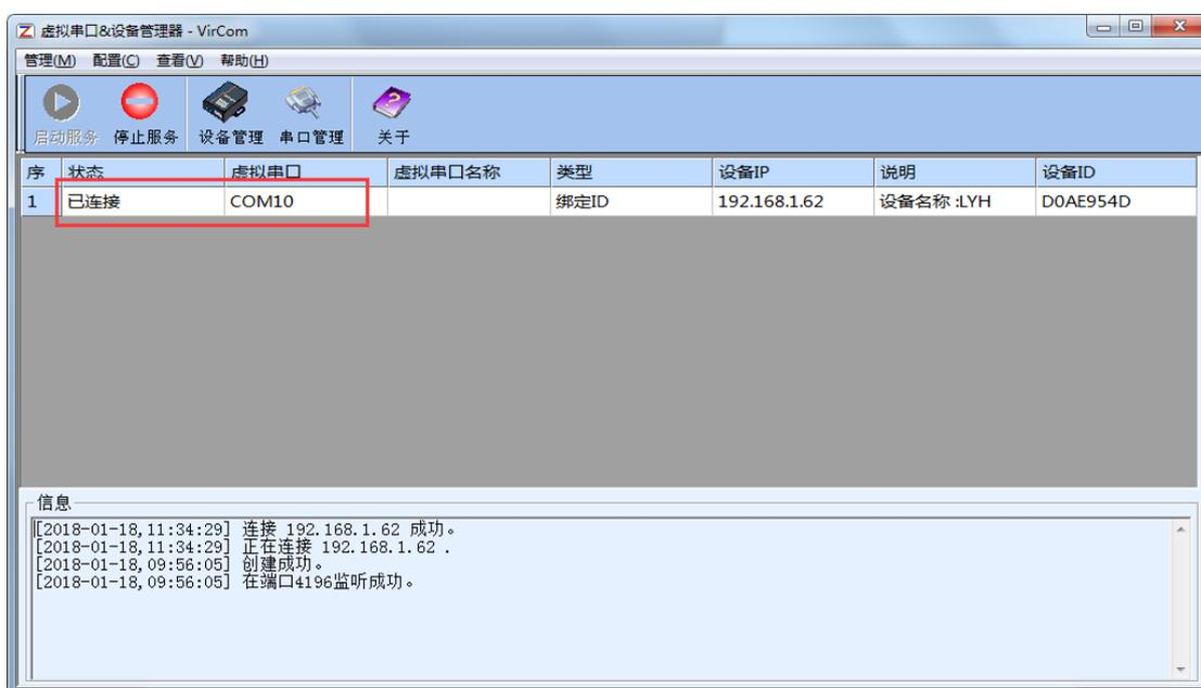
3、如果是网口设备，通过网线接在模块的网口上，然后打开通讯软件，在搜索网口设备的设置界面，找到输入 IP 地址搜索的功能，输入 127.0.0.1 来搜索，不再输入网口设备实际 IP 地址。
