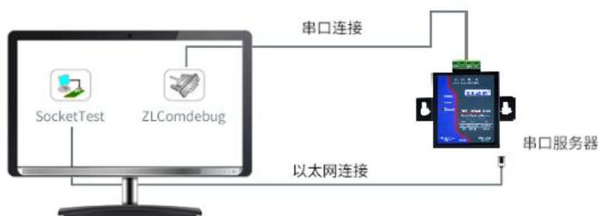
图 9 TCP 通讯示意图
