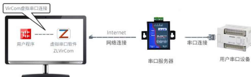
图 12 虚拟串口的作用
