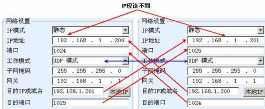
图 19 TCP 设备对联参数配置
