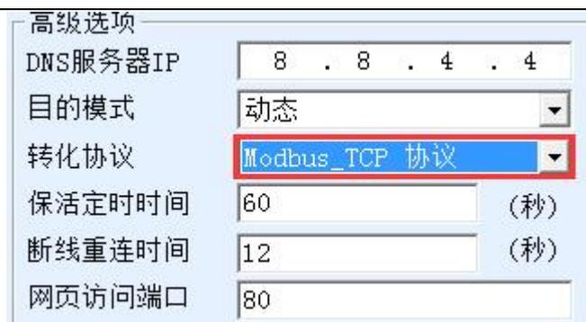
图 9 启用 Modbus TCP 功能
