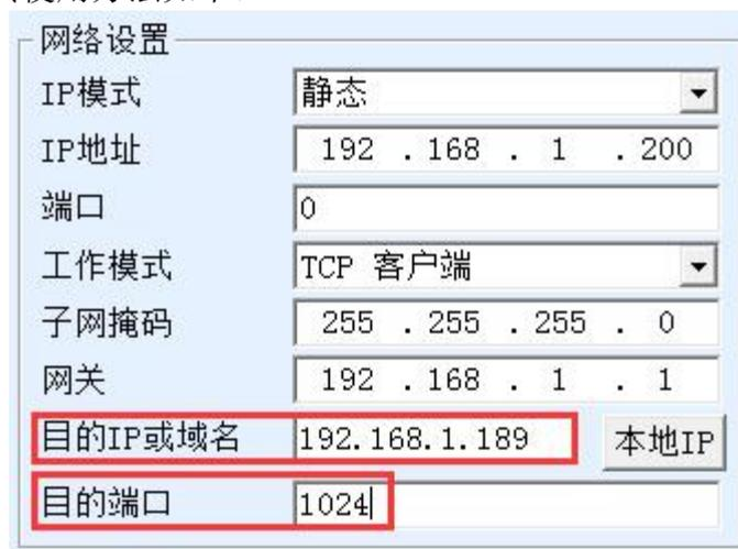
图 14 第一个目的 IP 和端口
