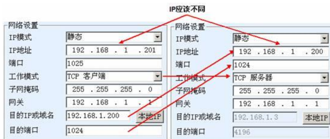
图 31 TCP 设备对联参数配置
