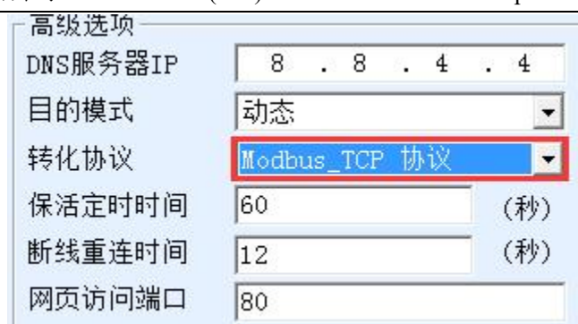
图 21 启用 Modbus TCP 功能
