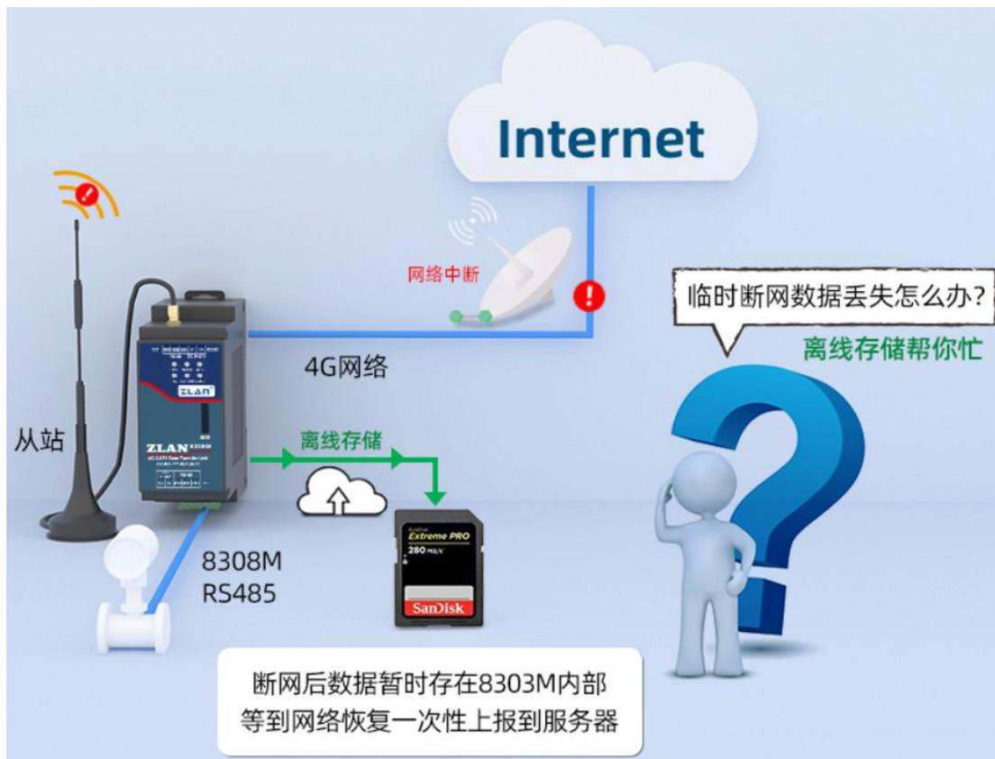
图 40 离线存储示意图
