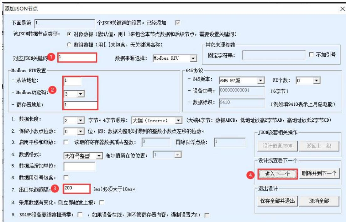
图 33 配置采集的关键词，寄存器地址以及采集间隔
