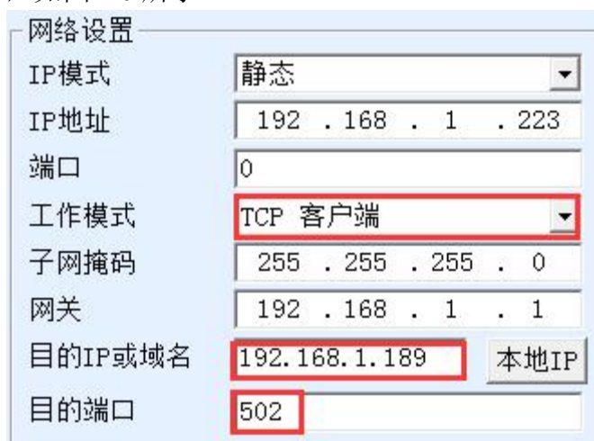
图 20 Modbus TCP 做客户端。
