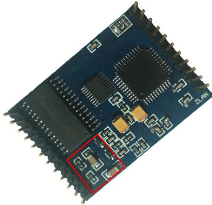
图 4 红框为 ZLSN2002I 独有 EMC 保护器件
