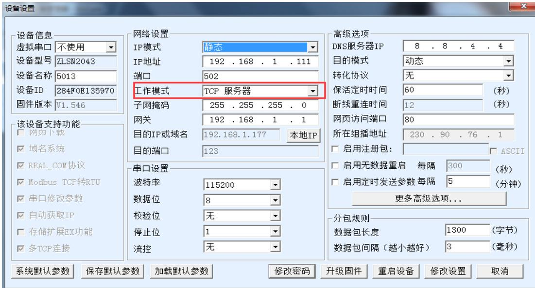
一般情况设置为 TCP 服务器模式，IP 模式静态，IP 地址和电脑保持一个网段，串口参数和你的串口设备保持一致。
