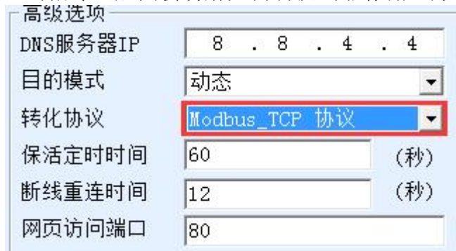
图 24 启用 Modbus TCP 功能
