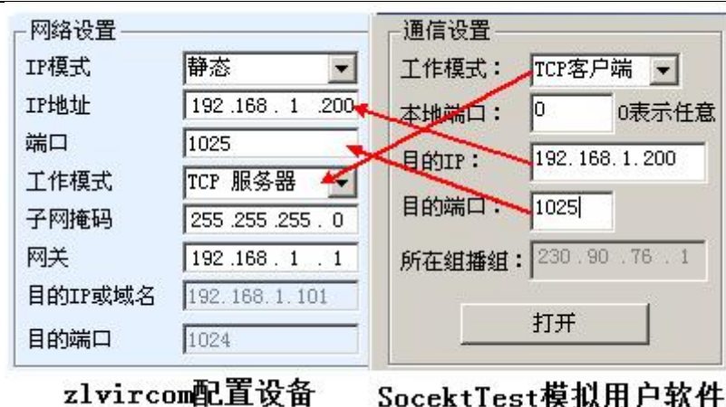
图 31 串口服务器作为服务端
