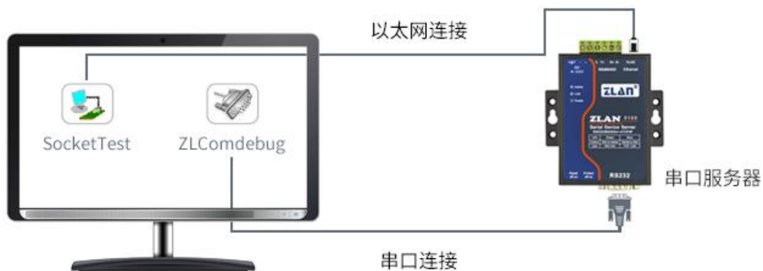
图 17 TCP 通讯示意图
