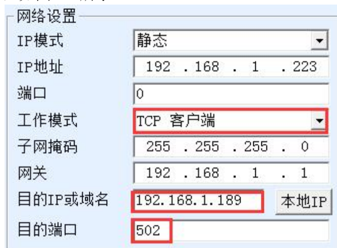
图 25 Modbus TCP 做客户端。
