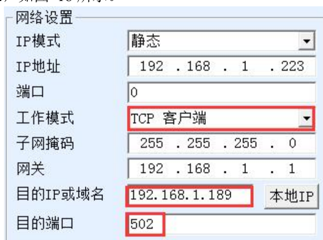
图 18 Modbus TCP 做客户端。
