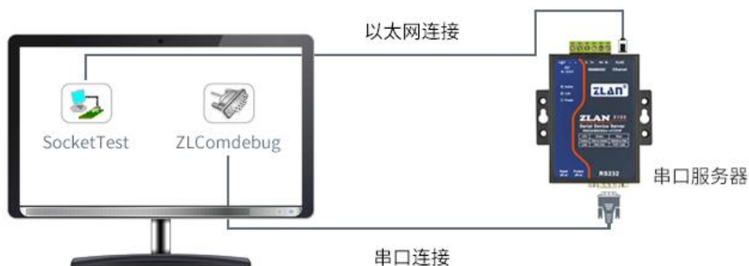
图 10 TCP 通讯示意图
