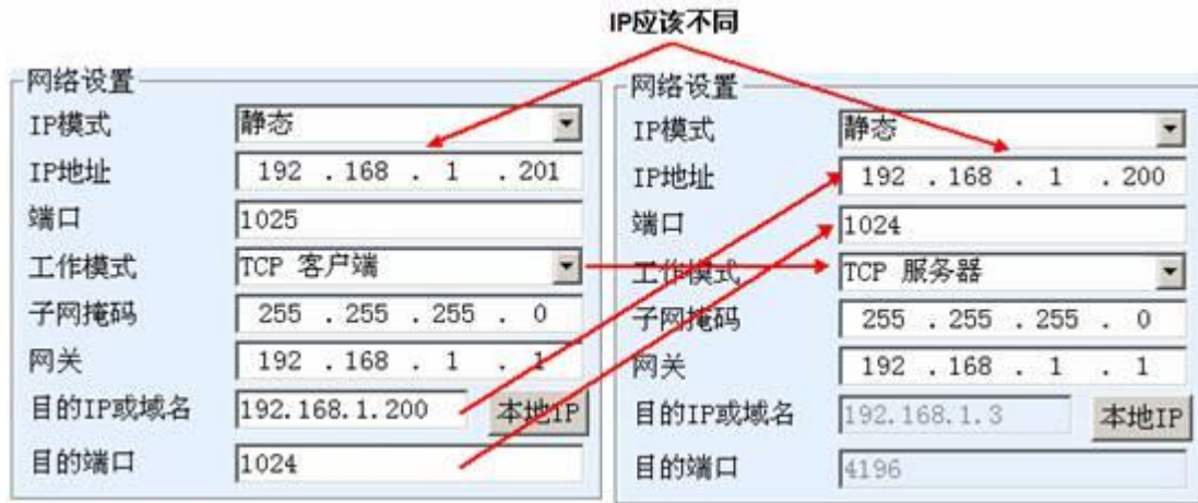
图 25 TCP 设备对联参数配置
