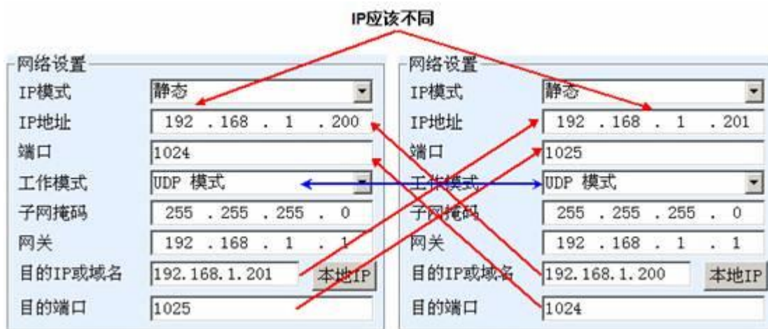
图 27 UDP 设备对联参数配置
