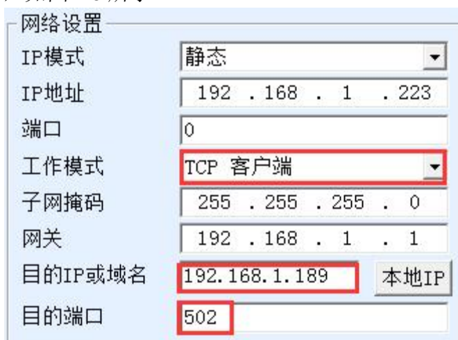
图 18 Modbus TCP 做客户端。
