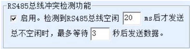
图 42 RS485 防冲突空闲时间
