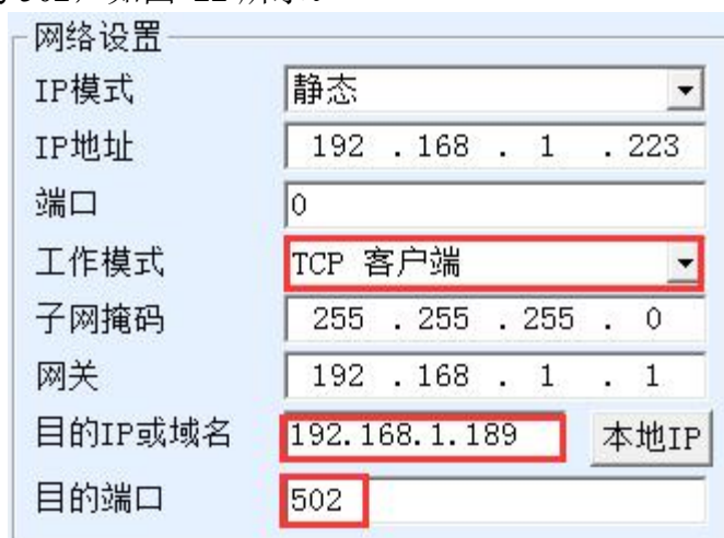
图 22 Modbus TCP 做客户端。
