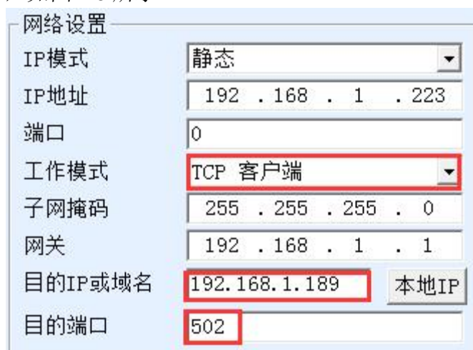
图 18 Modbus TCP 做客户端。
