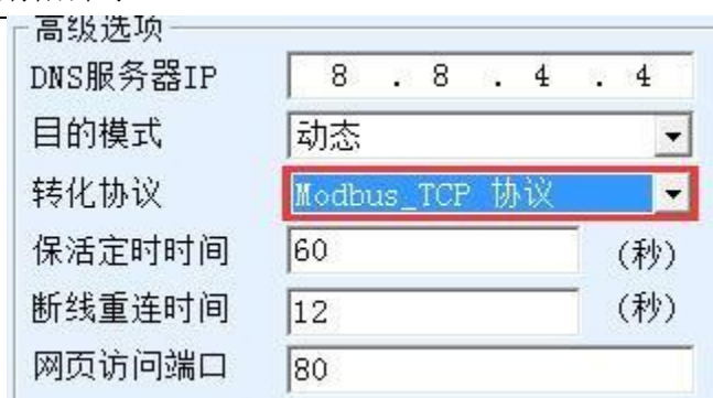
图 19 启用 Modbus TCP 功能
