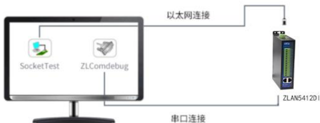
图 15 TCP 通讯示意图
