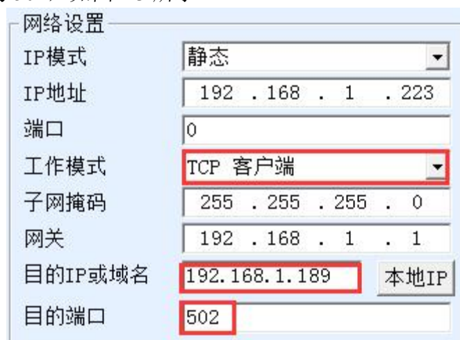
图 23 Modbus TCP 做客户端。
