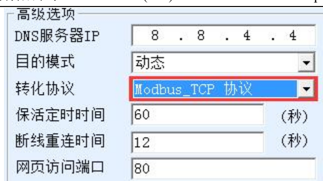
图 22 启用 Modbus TCP 功能
