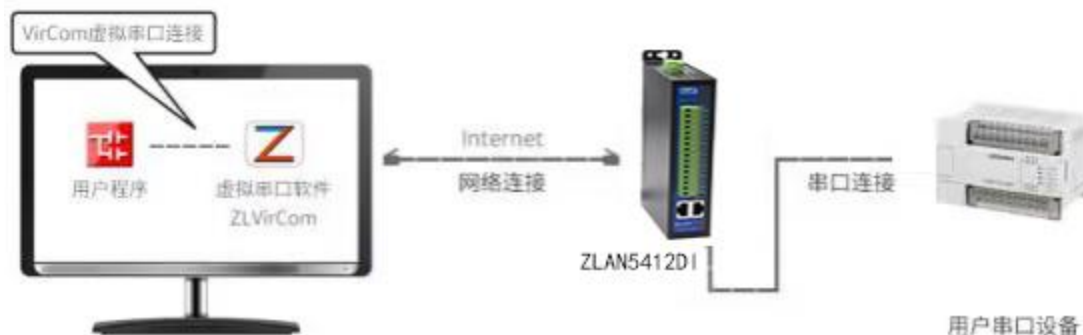
图 18 虚拟串口的作用
