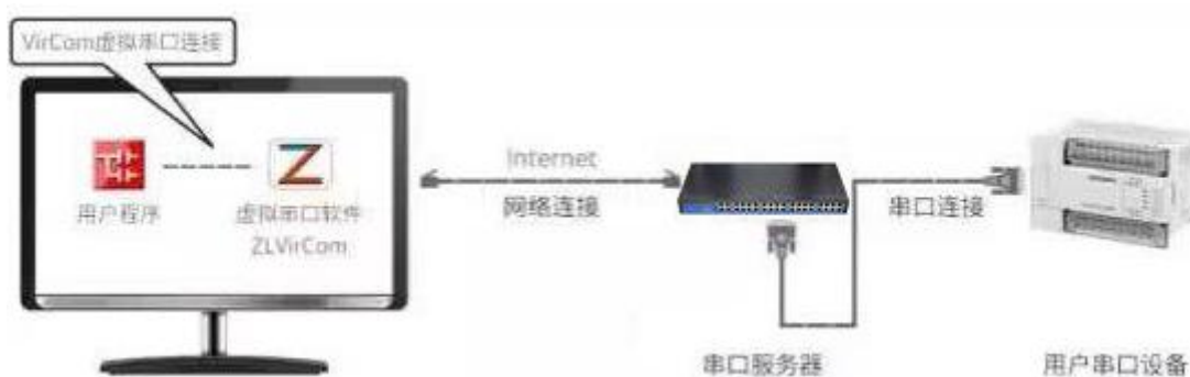
图 19 虚拟串口的作用
