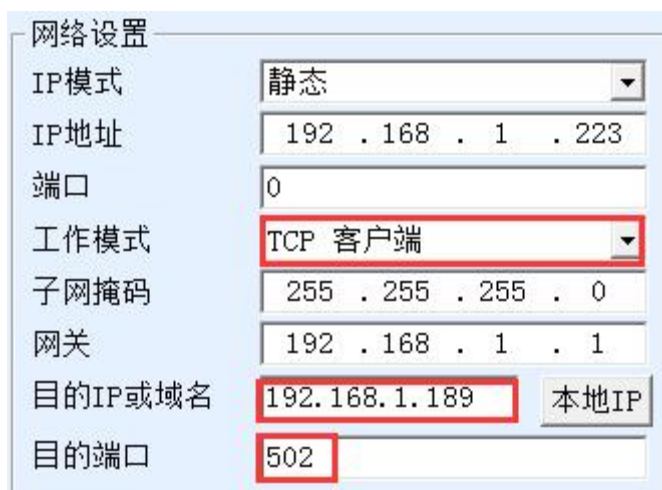
图 24 Modbus TCP 做客户端
