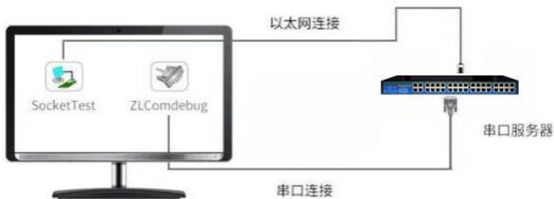
图 16 TCP 通讯示意图
