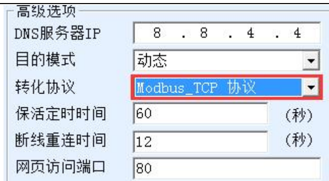
图 19 启用 Modbus TCP 功能
