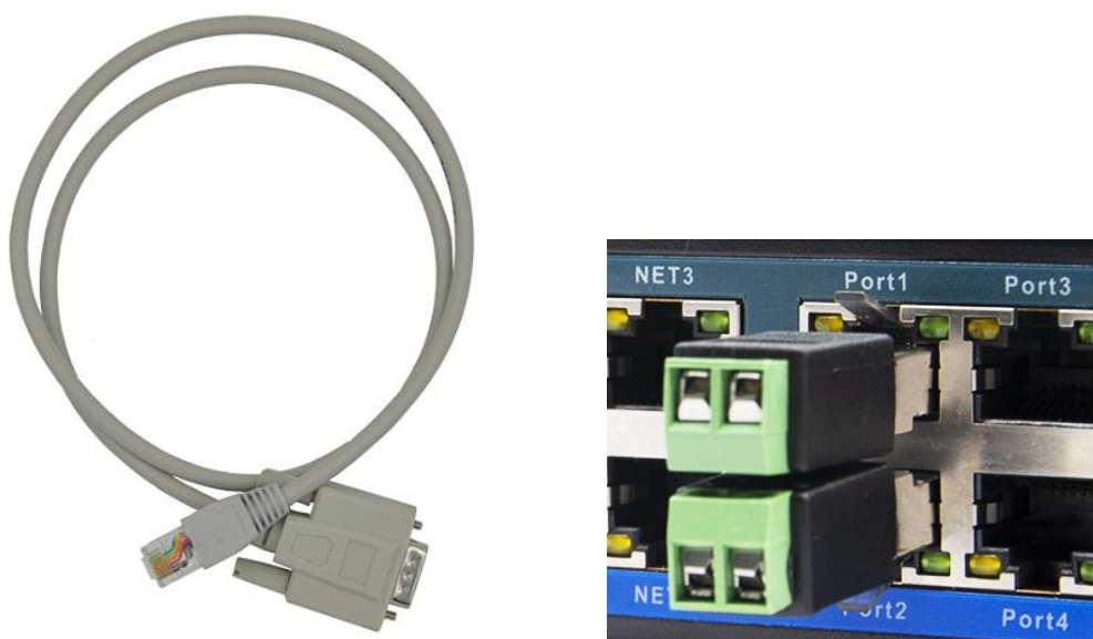
图 2 RS232 转接线和 RS485 转接端子
