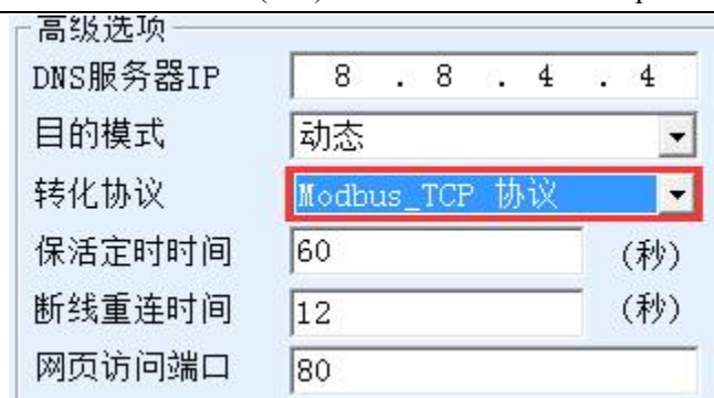
图 23 启用 Modbus TCP 功能
