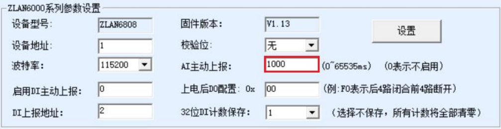
图 11 在 IO 控制器对话框设置 AI 主动上报时间
