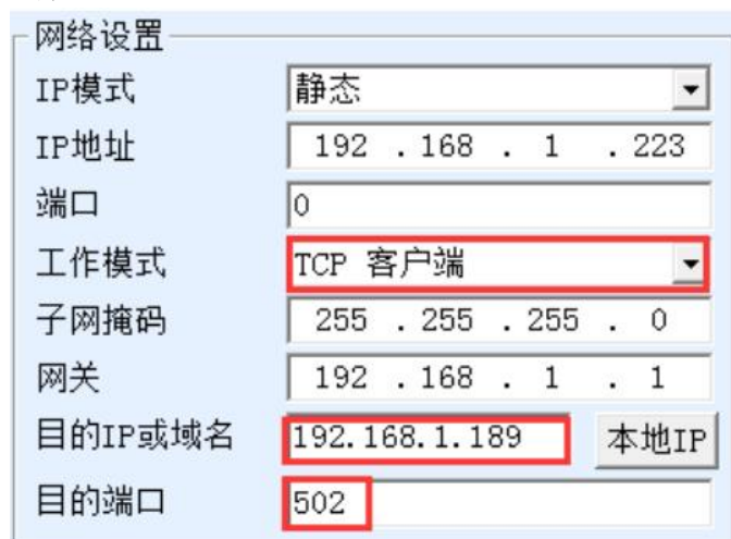
图 52 MODBUS TCP 做客户端
