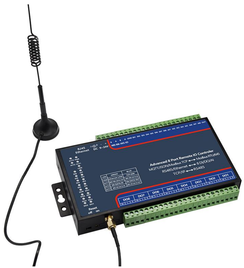
图 1 ZLAN6808I 远程 IO 控制
