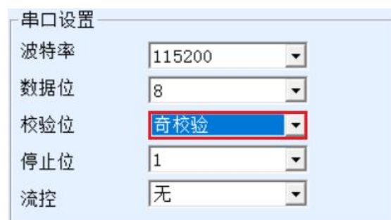
图 26 网络模块的校验位设置
