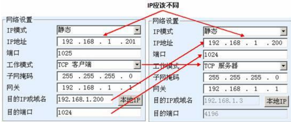
图 28 TCP 设备对联参数配置
