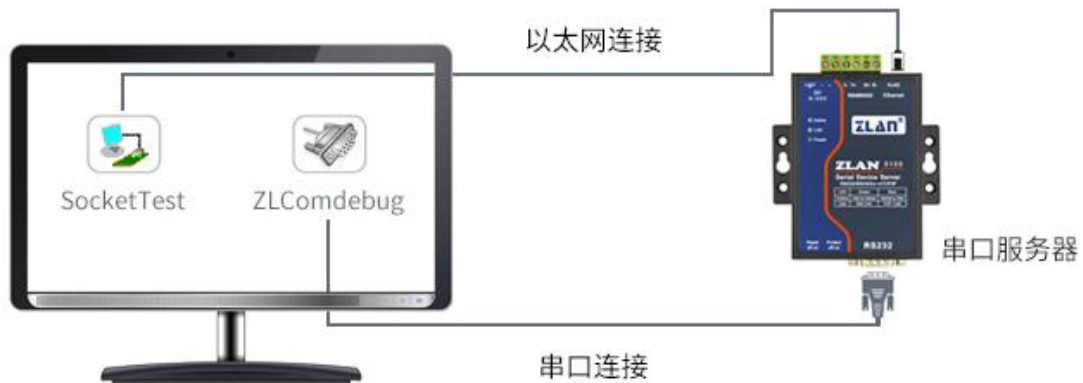
图 11 TCP 通讯示意图
