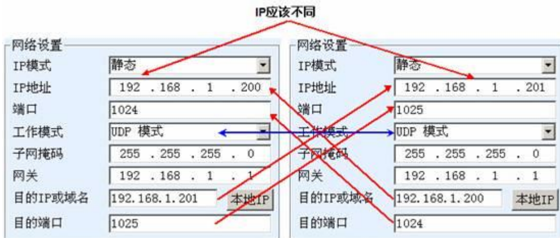
图 30 UDP 设备对联参数配置
