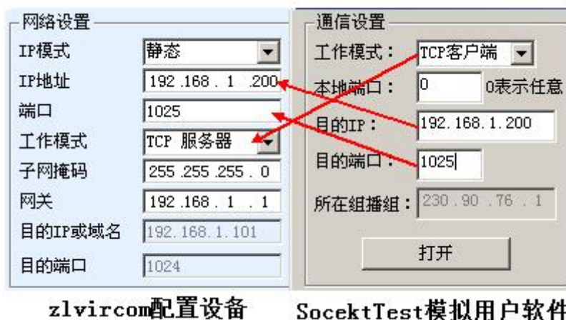
图 25 串口服务器作为服务端
