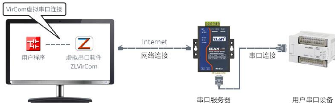
图 14 虚拟串口的作用
