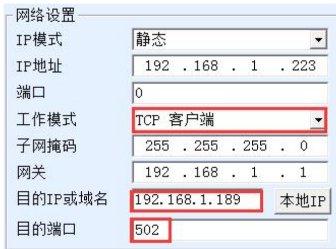
图 19 Modbus TCP 做客户端。
