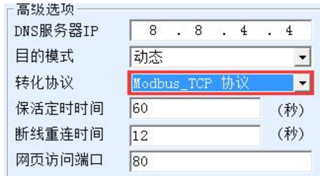
图 18 启用 Modbus TCP 功能
