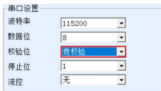
图 22 网络模块的校验位设置
